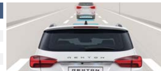
ESS – automatyczne włączanie świateł awaryjnych
